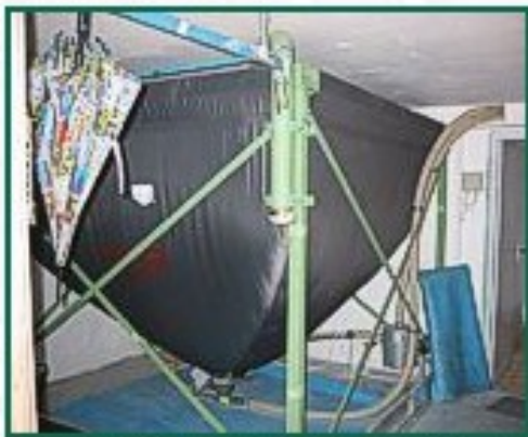
Flexible Silos: Leichte Montage, schonende Befüllung ohne Absaugung, einfache Entnahme
