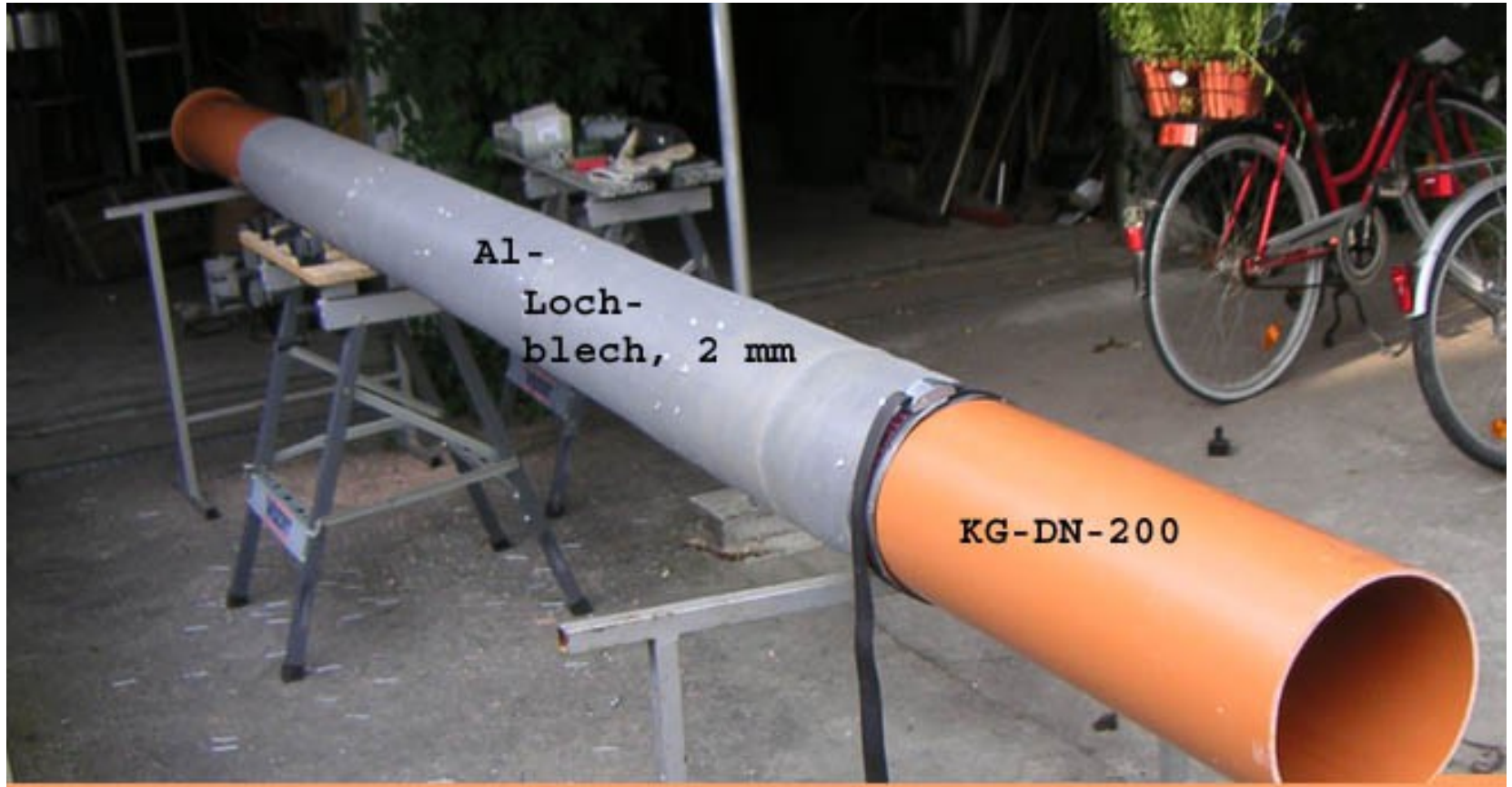
Brunnenfilter aus Alu-Lochblech und KG-Rohr DN-200, Länge ~ 4,5 Meter Rechts: Sumpfrohr, 3 Meter Al-Filter, 1 Meter Anschlußrohr Verlängerungen mit KG-DN-200
